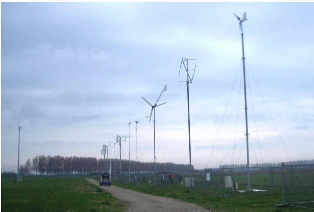
Figuur 2.1: Overzichtsfoto van de op het testveld Schoondijke geteste elf kleine windturbines en de meetmast voor meting van de windsnelheid.
